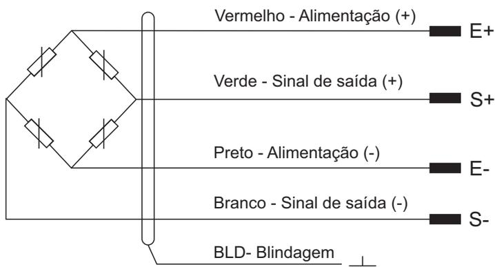
O cabo utilizado nesta célula de carga possui blindagem eletromagnética
